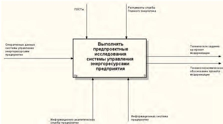
Рис. 5.8. Контекстная диаграмма бизнес-процесса предпроектных исследований в нотации структурно-функционального моделирования IDEF0
