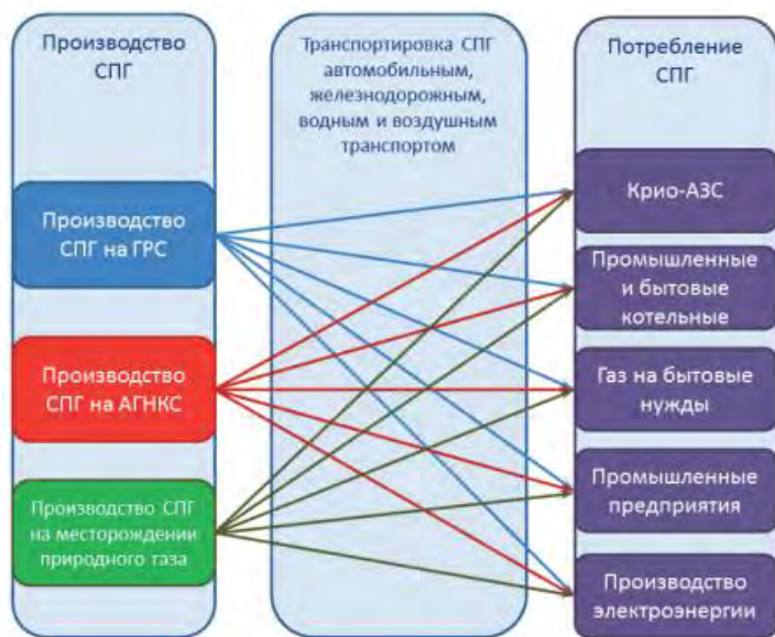
Рис. 2.2. Схема производства-потребления СПГ
